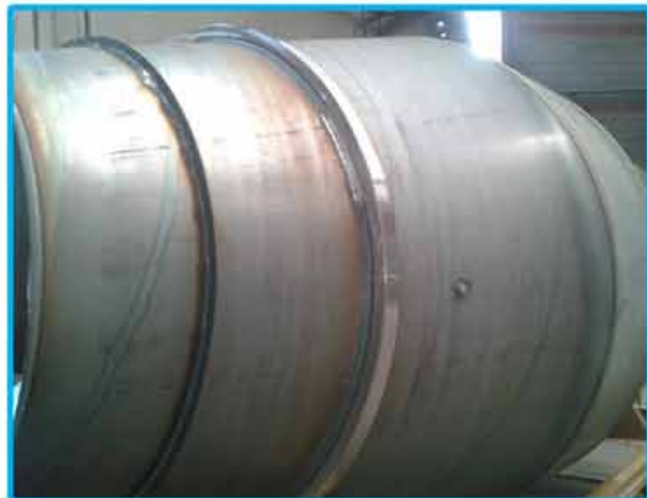
SOUDEURE EXTERNE EXTERNAL WELDING
