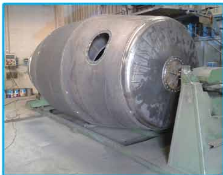
SOUDEURE EXTERNE EXTERNAL WELDING
